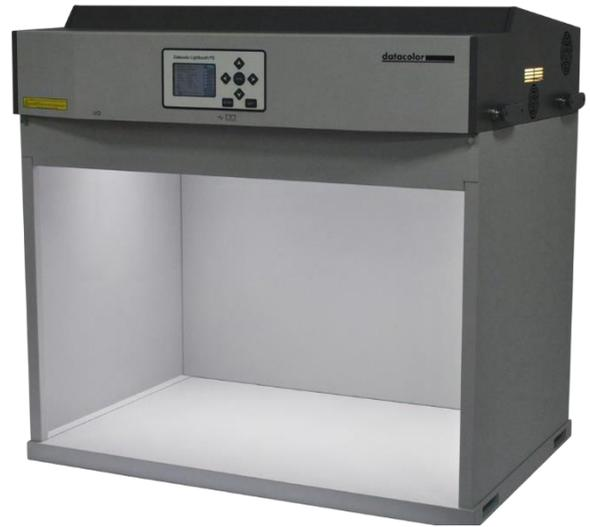
Las cabinas de luz PS Datacolor simulan diversas condiciones de iluminación, incluidas fuentes fluorescentes y LED, lo que permite a los analistas visuales del color evaluar cómodamente los colores de los productos con confianza y coherencia.
