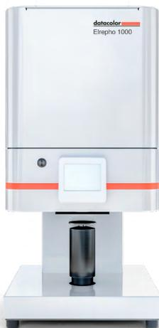
Datacolor Elrepho 1000 utiliza conexiones USB o Ethernet para interactuar con el software de control de calidad Datacolor Tools. Es compatible con los procedimientos de medición de la industria papelera definidos por las normas ISO, DIN, SCAN y TAPPI.
